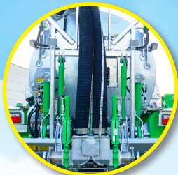
Hydrauliczny system przeciw wyciekaniu (TWIST)
